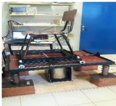
Figura 1: Cadeira na plataforma vibratória para teste de VCI
