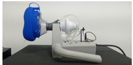
Figura 2: PAS modelo 6600 Kay Pentax® - equipamento utilizado para a coleta das medidas aerodinâmicas.
